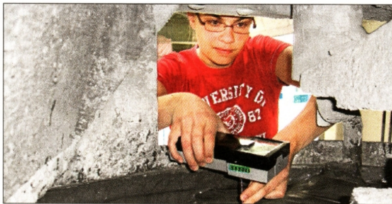
Sophia Hermann misst bei ihrem Versuch die Dichtmasse im großen Mischer. (Foto: privat)
